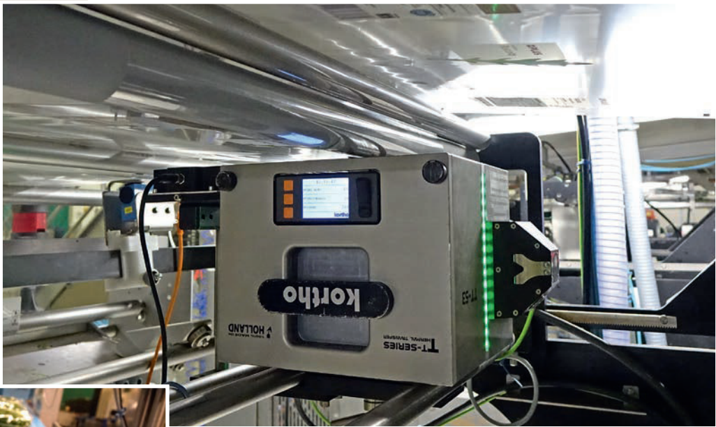
Las impresoras de transferencia térmica (TTO) de la serie TT de Kortho utilizan la tecnología patentada SMARTFORCE, que aplica electrónicamente el cabezal de impresión al sustrato.
